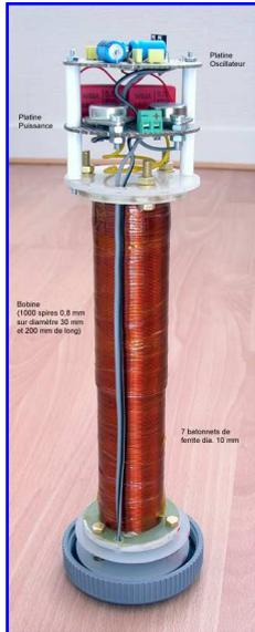
L'émetteur est aussi appelé barreau magnétique ou balise. Un circuit électronique constitué d'un oscillateur basse fréquence, d'un préamplificateur et d'un amplificateur de puissance attaque un circuit oscillant. La bobine est accordée sur la fréquence d'émission, ici 725 Hertz. Elle se comporte comme un aimant dont les pôles nord et sud s'inverseraient 725 fois par seconde.
